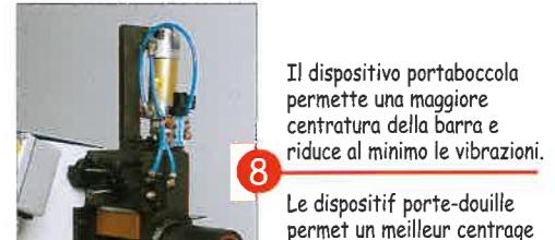
Il dispositivo portaboccola permette una maggiore centratura della barra e riduce al minimo le vibrazioni.
