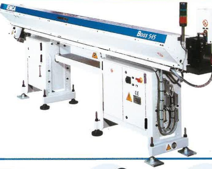
Caricatore automatico per barre di diametro da 4 a 32 mm (Boss 432) e da 5 a 45 mm (Boss 545) di lunghezza da 3200 a 4400 mm; ideale per applicazioni su torni CNC ed a camme, a fantina fissa o mobile.
